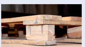
Sichtbare Befestigungselemente z.B. Nägel
